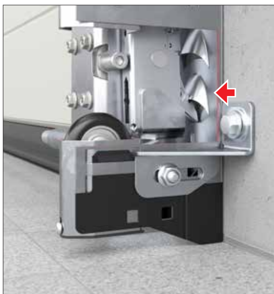
Kukica za zaključavanje kod zaštite od podizanja automatski se zakvači prilikom nasilnog podizanja vrata.
