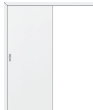
1-krilna klizna vrata tip C s okomitim okovima postavljena ispred zida
